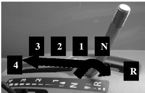
Esta palanca tiene seis posiciones para los cuatro engranajes delanteros, la posición neutra «N» y la marcha atrás para cambiar de marcha, presione el pedal (4.2) hasta la mitad y mueva la palanca según las indicaciones de la etiqueta.
