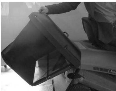
El recogedor de césped está lleno cuando los residuos de hierba permanecen en el césped. Si continúa el corte con el recogedor de césped lleno, puede bloquear el canal colector. Para vaciar el recogedor de césped:
